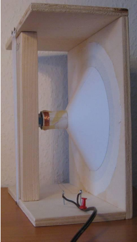
Spulenkörper hier 35mm lang, besser 20mm
