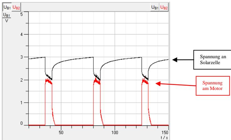
Das Cassidy-Diagramm zeigt einen typischen Spannungsverlauf.
