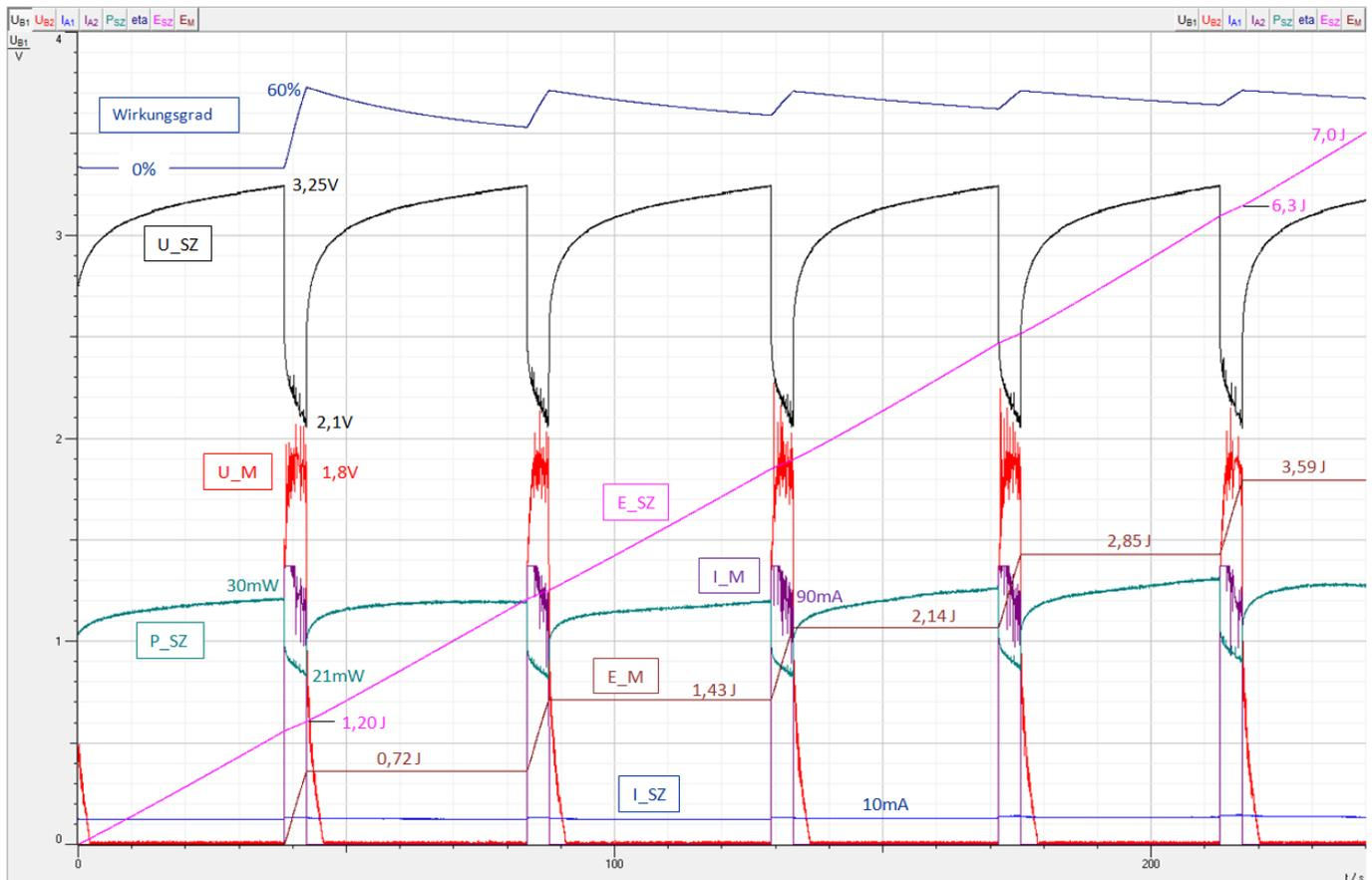
Die Spannung an der Solarzelle schwankt hier zwischen 2,1V und 3,25V. Ein Zyklus dauert etwa 45s, davon etwa 41s Aufladezeit und etwa 4s Motorlaufzeit.
